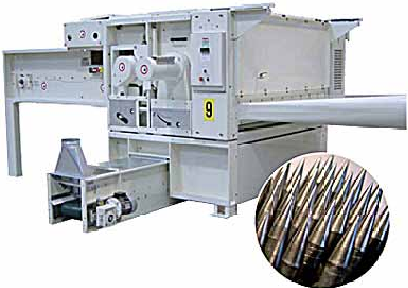
Figuur 4: 1 Laroche jumbo-unit met detail beslag van trommels
